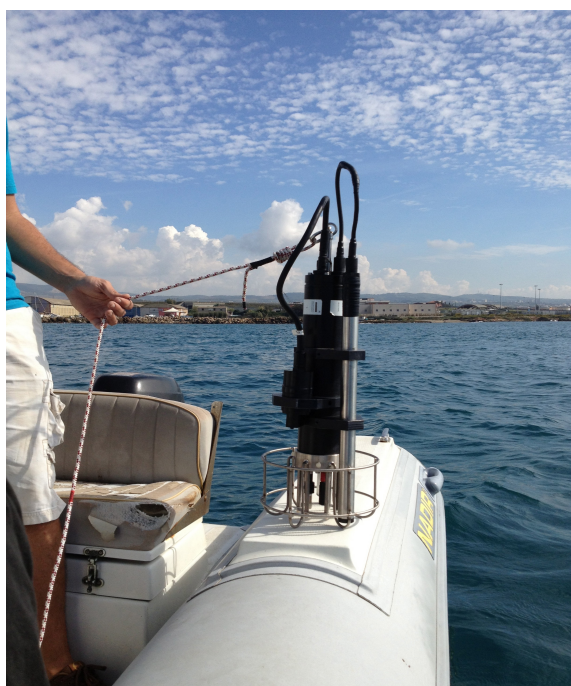
Fig. 4 Profili verticali con Sonda multiparametrica
